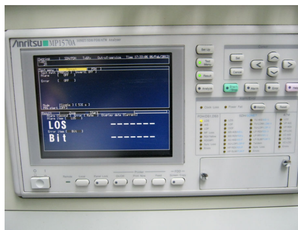
Слика 3.16 SDH анализатор грешке сигнала Anritsu MP1570A/A1
