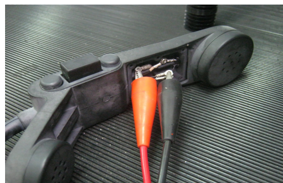
3.36 Начин прикључења МТК на осцилоскоп
