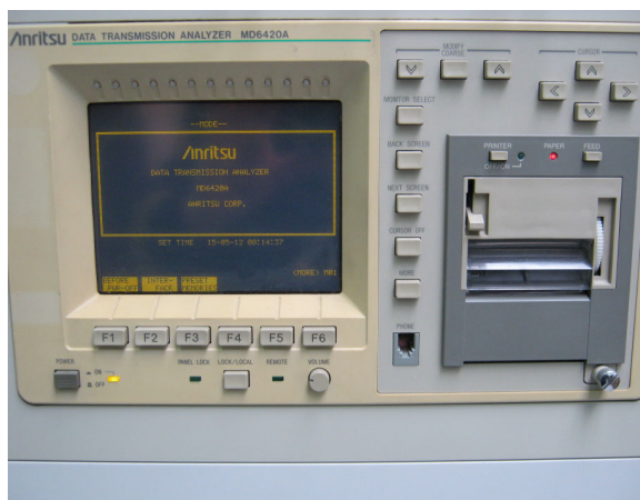
Слика 3.21 PDH анализатор грешке сигнала Anritsu MD6420A
