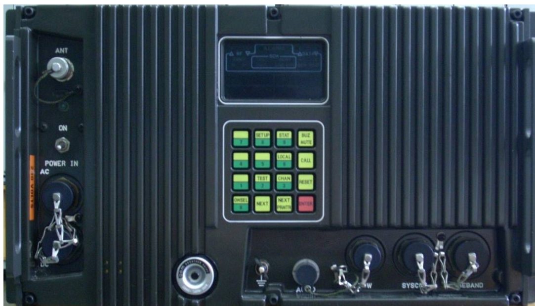
Слика 2.5 Радио-релејни уређај GRC 408E
