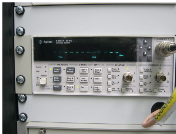
Слика 3.18 Бројач фреквенције Agilent 53131A
